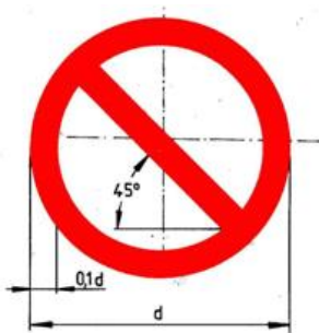
Señal de prohibición
